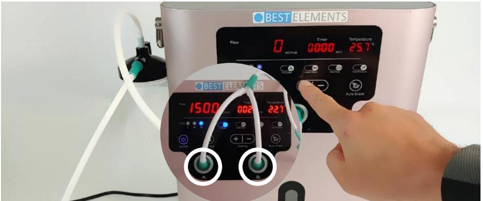
Der Wasserstoffgenerationsprozess beginnt. „Flow 1500 ml/min“ erscheint. Es leuchtet im Fenster blau und es steigen Bläschen auf. Es strömt nun ein Luftgemisch von **66% Wasserstoff aus der Öffnung H<sub>2</sub> (1.000 ml/min) und 33% Sauerstoff aus der Öffnung O<sub>2</sub> (500 ml/min)** über die Nasenkanüle zusätzlich zu Ihrer Atemluft. Sie können H<sub>2</sub> einzeln inhalieren oder mit beiliegendem Y-Stück kombiniert mit O<sub>2</sub>.
