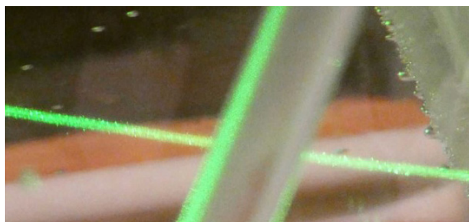
1 Laser machen H2-Nanobläschen im Wasser sichtbar
